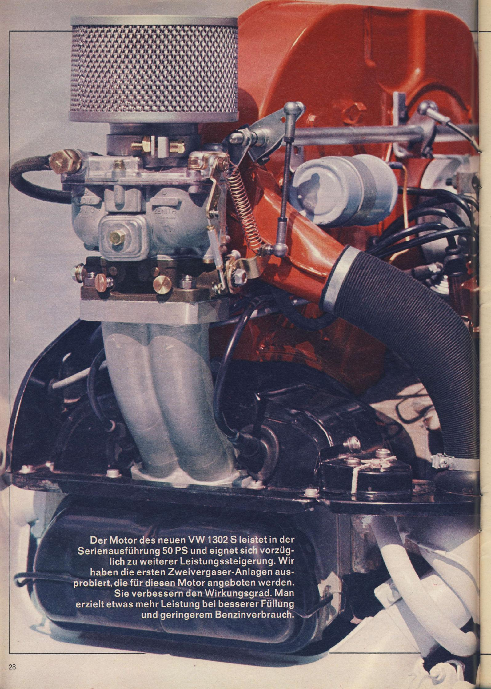
Der Motor des neuen VW 1302 S leistet in der Serienausführung 50 PS und eignet sich vorzüglich zu weiterer Leistungssteigerung. Wir haben die ersten Zweivergaser-Anlagen ausprobiert, die für diesen Motor angeboten werden. Sie verbessern den Wirkungsgrad. Man erzielt etwas mehr Leistung bei besserer Füllung und geringerem Benzinverbrauch.
